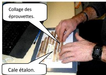
**Figure 2: Collage des éprouvettes.**
