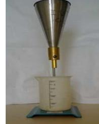
Figure 2. Essai au cône de Marsh.
