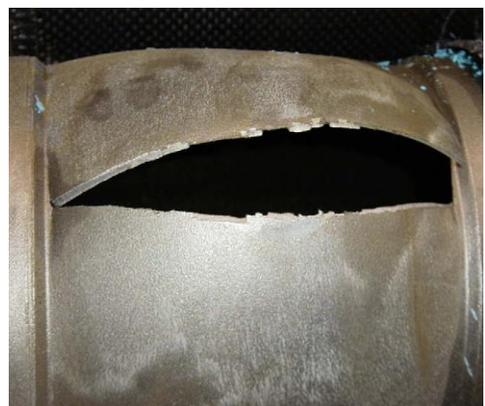
**Figure 6** Exemple d'un tube éclaté avec un défaut axisymétrique [5].
