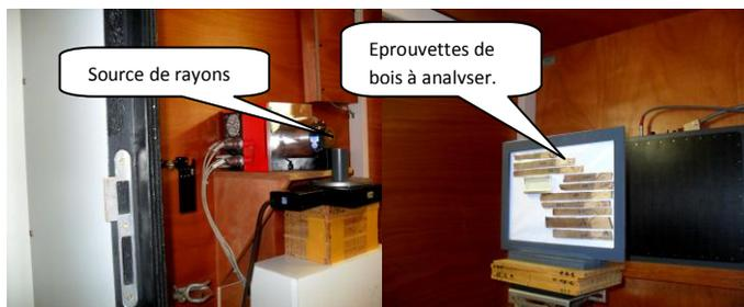
**Figure 3: Emplacement de la tablette à échantillons.**
