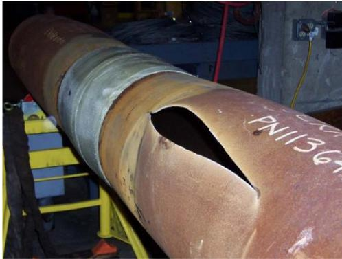
**Figure 9.** Rupture dans la section du matériau de base après un test d'éclatement [10].
